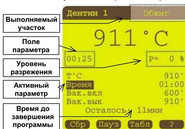
**5.5.6.3** ВН включается при закрытой камере и нагреве до заданной температуры **Вак.вкл.** На время набора уровня разрежения от 0 до 90% автоматически включается поддержание температуры включения ВН (нагрев приостановлен), на дисплее – сообщение **ПАУЗА**.
