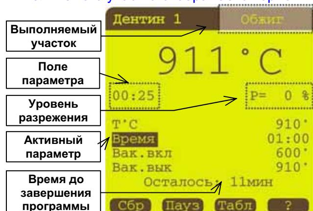
**5.5.6.3** ВН включается при закрытой камере и нагреве до заданной температуры **Вак.вкл.** На время набора уровня разрежения от 0 до 90% автоматически включается поддержание температуры включения ВН (нагрев приостановлен), на дисплее – сообщение ПАУЗА.
