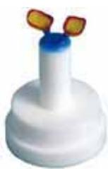
Сверните пленку для паковки в цилиндр, который одним концом оденьте на подставку, а другим - на стабилизирующее кольцо (**B**) и закрепите скотчем. Стык пленки рекомендуется загладить с помощью воска для исключения трещин при паковке. Выньте подставку и приклейте на воск штифты с восковыми моделями (см. рисунок), после чего подставку аккуратно установите обратно.
